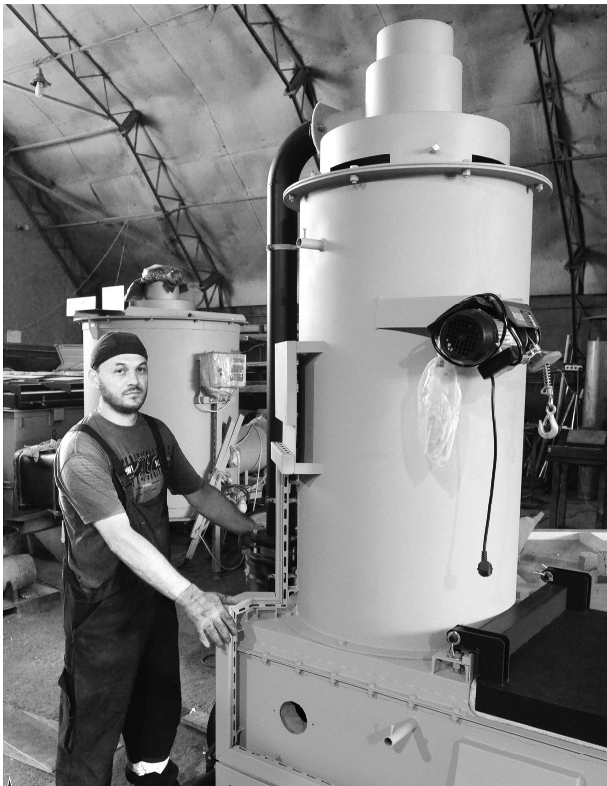
▲ Электросварщик Александр Рожков выполняет работы по изготовлению инсинератора
