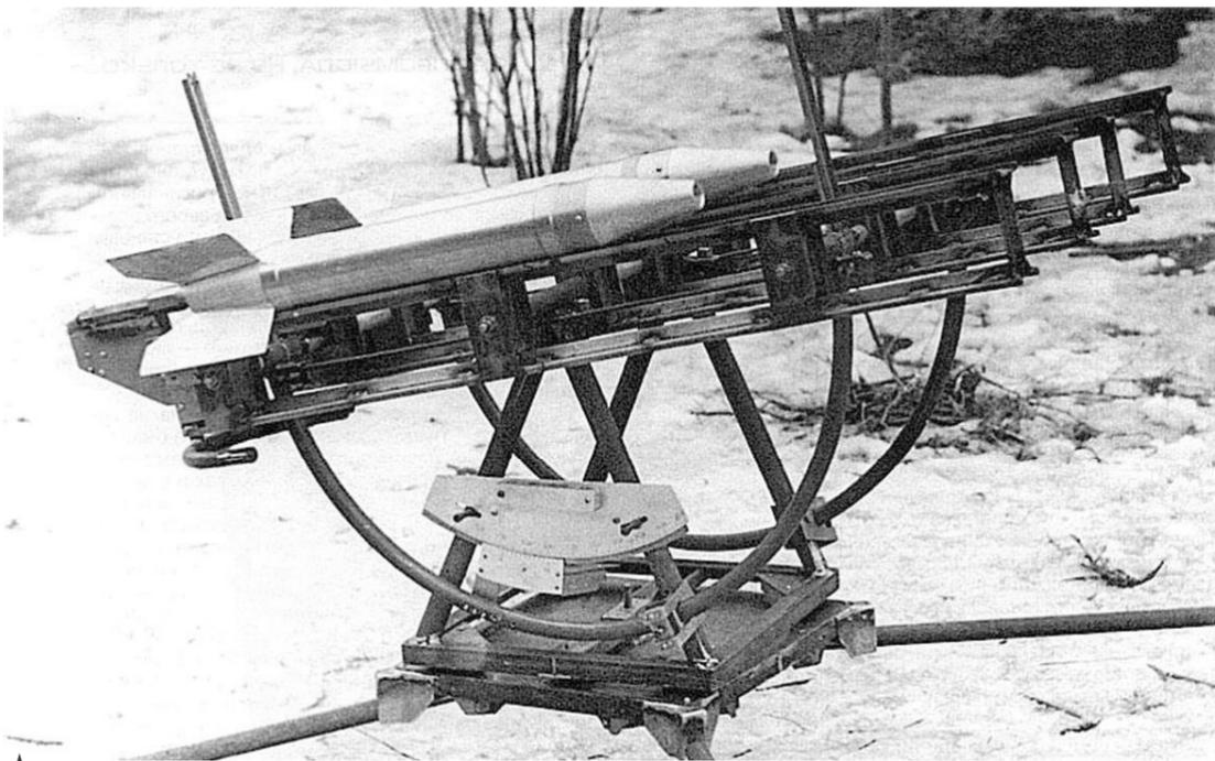
▲ Общий вид 8-зарядной горно-вьючной пусковой установки М-8
